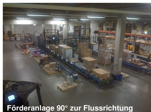
**Förderanlage 90° zur Flussrichtung**
